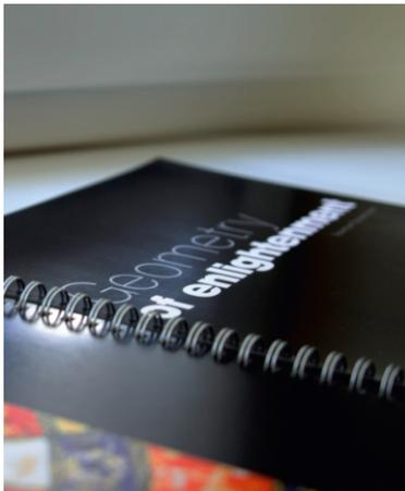
**Брошюровка / переплет** - это конечный этап работ, связанный со скреплением страниц между собой и с обложкой. Есть три вида переплета документов: термопереплет (клеем) и на
